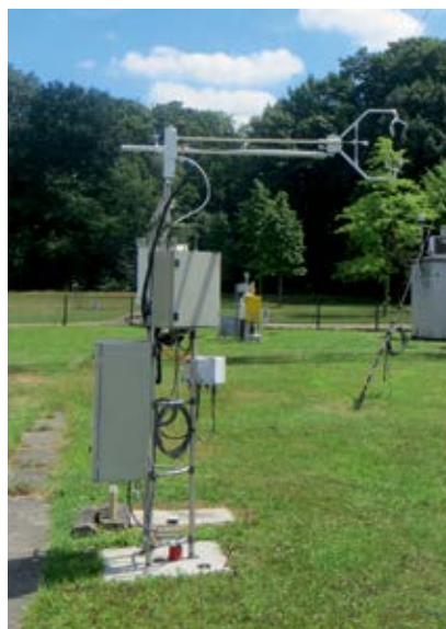
Afb. Meetsysteem van de turbulentiestromen in testfase in Ukkel in 2016 (onder) en de details van de sonische anemometer (boven).
