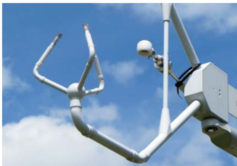
Afb. Meetsysteem van de turbulentiestromen in testfase in Ukkel in 2016 (onder) en de details van de sonische anemometer (boven).
