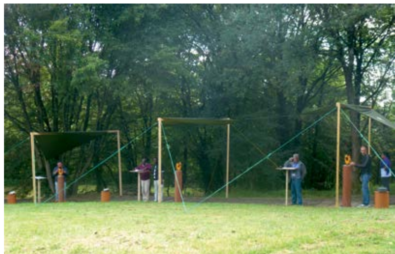
Onderlinge vergelijking van absolute metingen: 3 teams meten de inclinatie en de declinatie van het aardmagnetisch veld.
